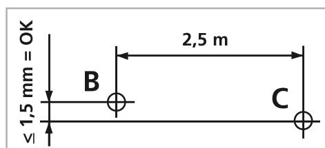
ca. 2,5 m nach rechts schwenken und Punkt C markieren. Überprüfen Sie, ob die waagerechte Linie von Punkt C  $\pm 1,5 \text{ mm}$  auf der gleichen Höhe mit dem Punkt B liegt. Vorgang durch Schwenken nach links wiederholen.
