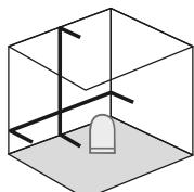
Løsn transportsikringen, og skub skydekontakten (2) til højre. Laserkrydset vises.
