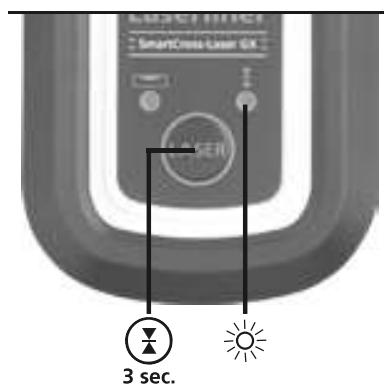
Le linee laser iniziano a pulsare a una frequenza elevata e la loro luminosità diminuisce. Il pulsare delle linee laser permette al ricevitore laser di riconoscerle.
