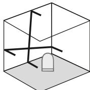
Ne pas dégager le blocage de transport, faire glisser l'interrupteur à coulisse (2) vers la gauche. Il est maintenant possible de travailler sur des plans inclinés. Il n'est pas possible d'effectuer un nivellment horizontal ou vertical dans ce mode étant donné que les lignes laser ne s'orientent plus automatiquement. Les lignes laser clignotent en vert.
