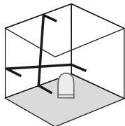
Løsn ikke transportsikringen, skub skydekontakten (2) til venstre. Nu kan der anlægges skæve niveauer. I denne modus kan der hverken nivelleres horisontalt eller vertikalt, da laserlinjerne ikke længere indjusterer sig automatisk. Laserlinjerne blinker grøn.
